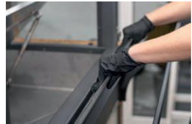
Zuerst Schneidebrett abnehmen, danach Spiegel anheben, zu sich ziehen und nach unten klappen.
