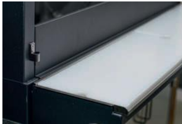
Bei hochgeklapptem Spiegel die Schneidbrettauflage wieder einschieben, bis diese in die vorgesehene Position einrastet. Achten Sie darauf, dass der Winkel in Richtung Gerät zeigt.
