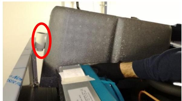
5. Die sechs Schrauben lösen, die den Lüfter am Verdampfer festhalten.
