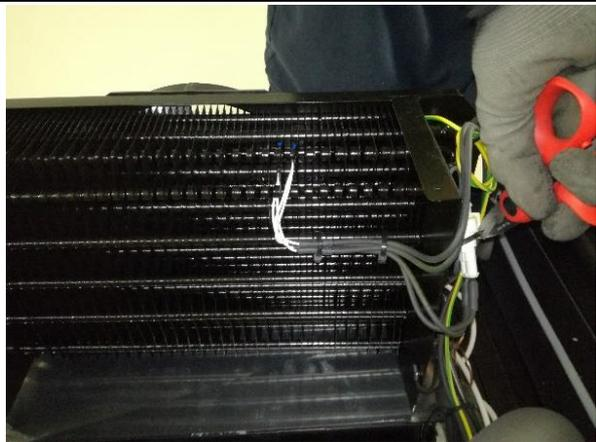
6. Den Steckverbinder der Heizungskabel trennen.
