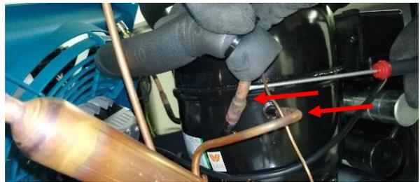
5. Den Verdichter entfernen, dazu die entsprechenden Verankerungssysteme betätigen.
