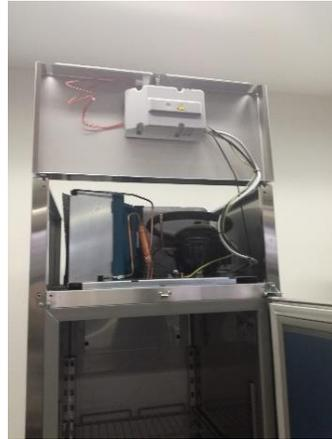
3. Die mittlere Schraube zum Schließen der Frontblende lösen.
