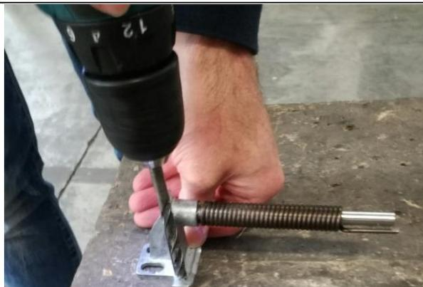
6. Die rechte Feder gegen die linke Feder austauschen, die durch den Verlauf der Spirale gegen den Uhrzeigersinn erkennbar ist, und diese in das Scharnier einsetzen.
