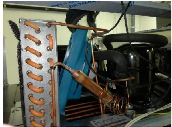
5. Die Schrauben zur Befestigung des Lüfters am Förderer lösen und den Lüfter auswechseln; nicht vergessen, die Lüfterräder in Richtung Ansaugung zu positionieren.
