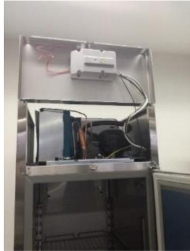
3. Die vier Schrauben zur Befestigung des Förderers am Verflüssiger lösen.
