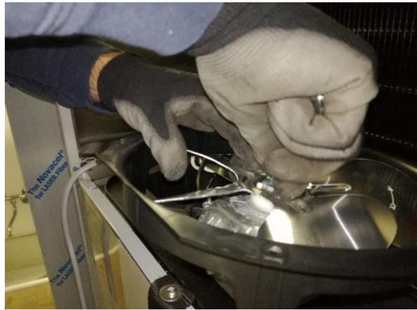
8. Die vier Schrauben lösen, die den Lüftermotor am Förderer festhalten.
