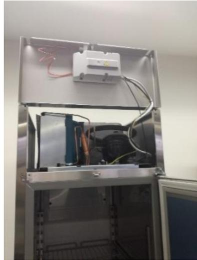
3. Die Verteilerdose entfernen und dazu die beiden Verschlusschrauben lösen.
