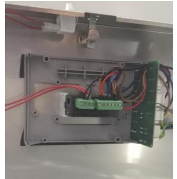
17. Die Verteilerdose schließen, dazu die beiden Verschlusschrauben festziehen.
