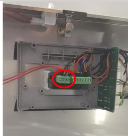
5. Den Verdampferfühler von der Platine trennen (siehe elektrischen Schaltplan).
