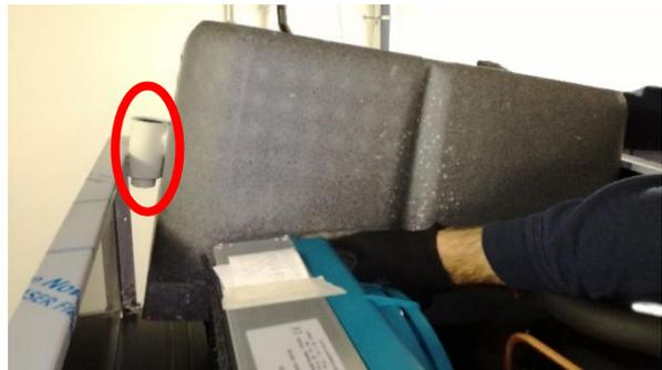
5. Die Schellen zur Blockierung der Kabel abschneiden.
