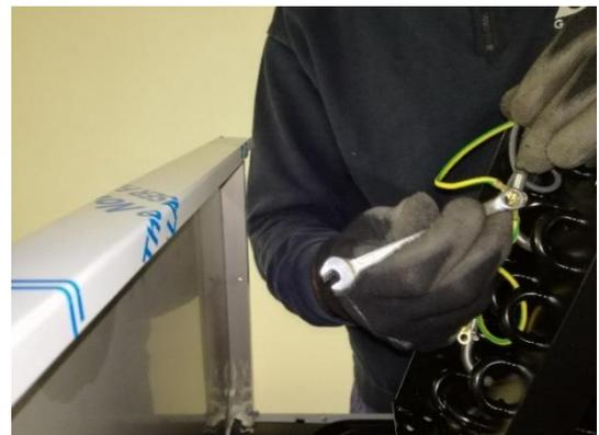
**13.** Die Kabel wieder in den Steckverbinder einführen.
