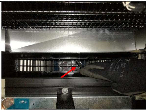
12. Den Fühler auswechseln, dazu das Klebeband trennen, das ihn festhält.
