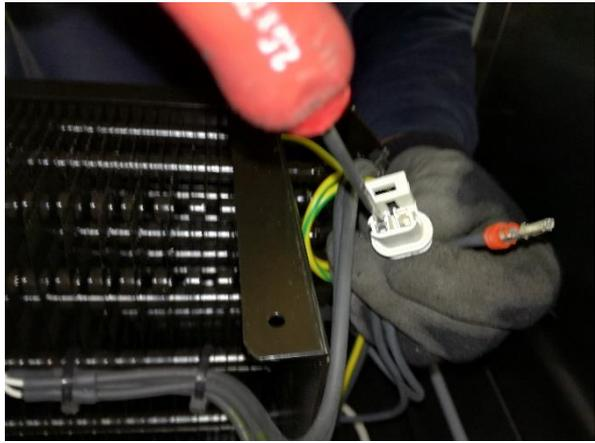
**8.** Die Schellen zur Blockierung der Kabel abschneiden.
