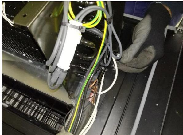
6. Die Schellen zur Blockierung der Kabel abschneiden.
