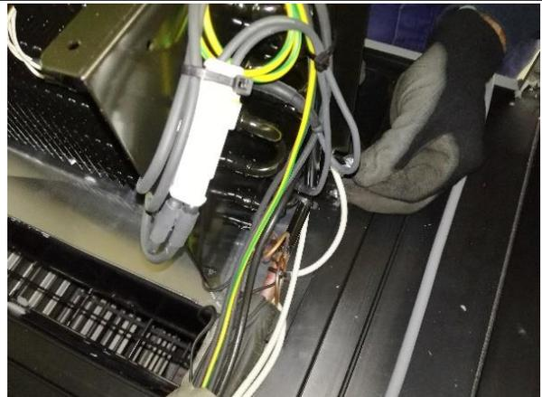
7. Das Klebeband entfernen, das den Heizung an der Basis festhält.
