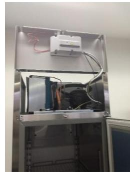
3. Die Steckverbinder für den Anschluss vom Türkontaktschalter entfernen.
