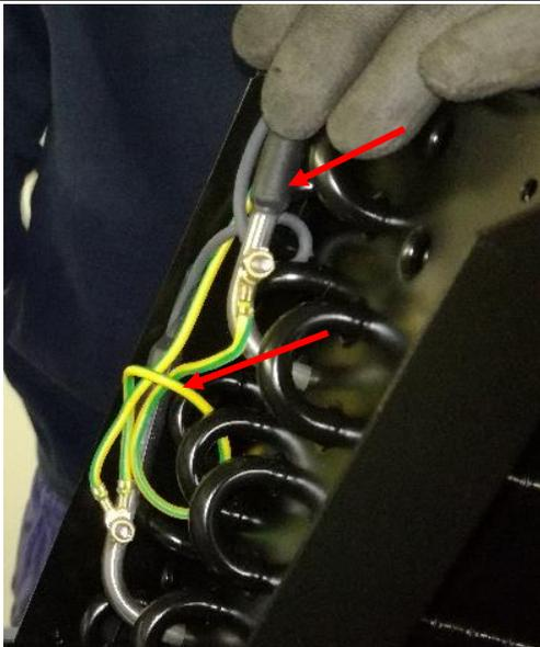
**10.** Die Heizung auswechseln und ihn dazu aus den Bohrungen am seitlichen Bügel des Verdampfers ziehen.
