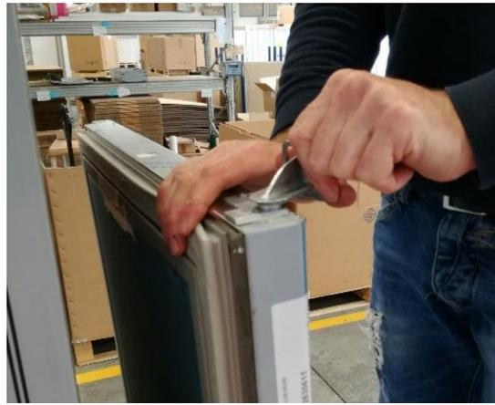
15. Das obere Scharnier am Chassis befestigen.
