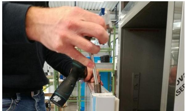
5. Das obere Scharnier mit einer Spitze  $\varnothing 7$ , wie in der Abbildung angezeigt, durchbohren, um die Bohrung links zu öffnen.
