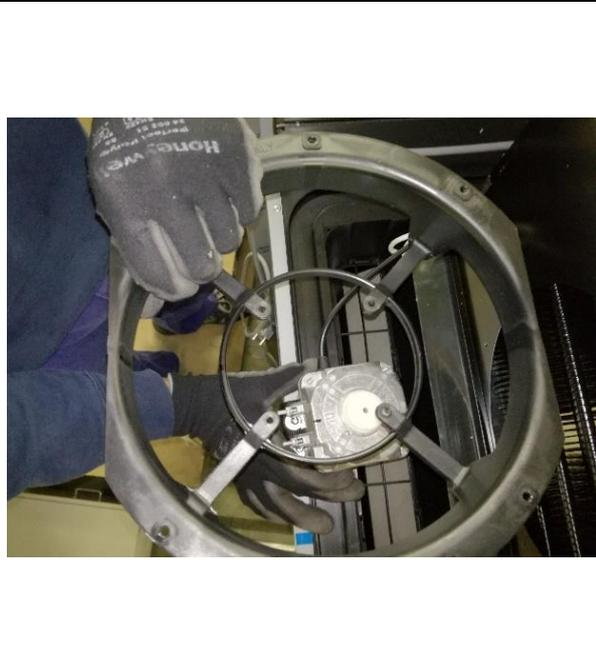
10. Den Lüftermotor auswechseln und wieder am Förderer positionieren.
