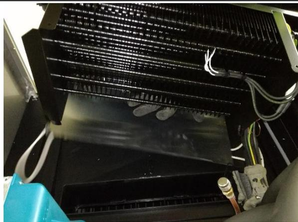
9. Die Schraube zur Befestigung des Behälters lösen.
