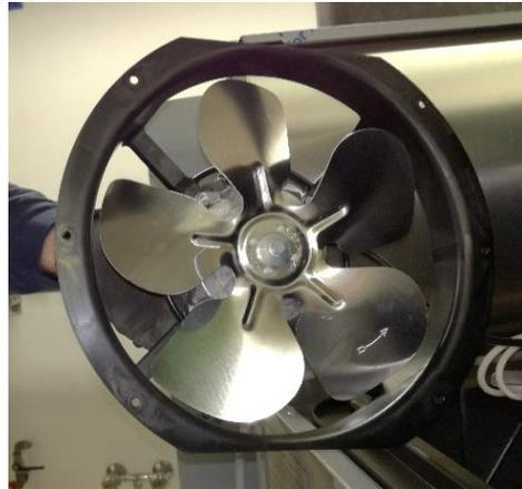
7. Die Mutter lösen, die das Lüfterrad am Lüftermotor festhält.
