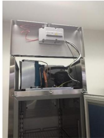
3. Die Verteilerdose entfernen und dazu die beiden Verschlusschrauben lösen.
