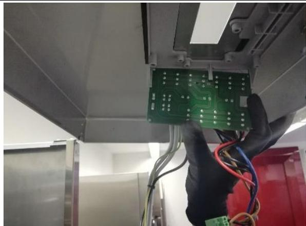
8. Die Klemmenbretter wieder an der Platine anschließen.
