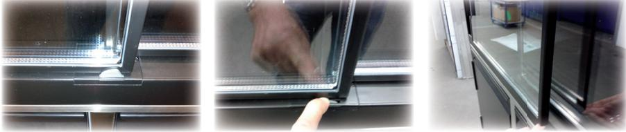
Drücken Sie zur **Reinigung** die Scheibensicherung der äußeren Scheibe nach unten und ziehen die Scheibe unten nach vorne. Sie können beide Scheiben nun auf der gesamten Länge verschieben, so dass die gesamte Scheibenfläche gereinigt werden kann. Achten Sie darauf, die Scheibe nicht am Griff der hinteren Scheibe schleifen zu lassen, da es sonst zu Kratzern auf der Scheibe kommen kann.
