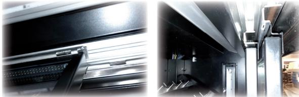
Zum **Entfernen** der Scheibe heben Sie diese unten an und ziehen sie oben nach vorne. Wichtig: die Scheibe sollte möglichst senkrecht gehalten werden. Sie können die Scheibe nun vorsichtig nach unten entnehmen. Verfahren Sie bei der zweiten Scheibe genauso. Achten Sie beim Wiedereinsetzen unbedingt darauf, dass die Nasen der Führungsschiene wieder in den entsprechenden Aussparungen der Scheibenhalteschiene einrasten.
