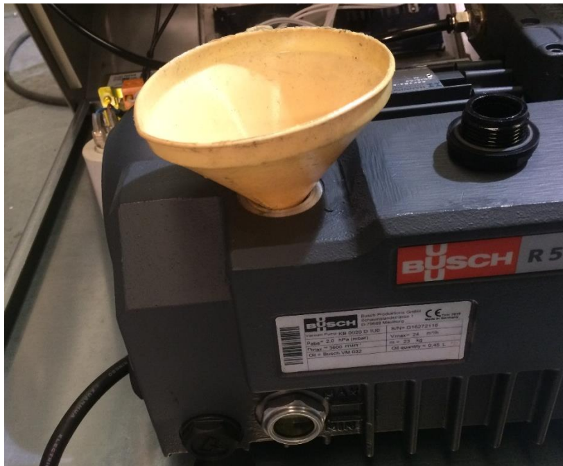
Abbildung 7. Öleinfülldeckel entfernen und frisches Öl einfüllen
