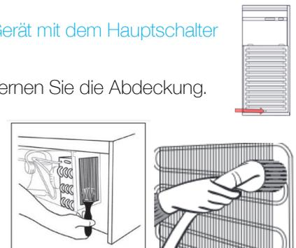
Abbildung 14: Kondensator reinigen
