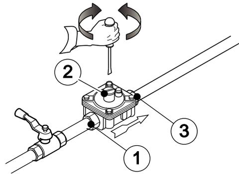
**Für Australien:** Den Prüfanschlussdruck justieren, während die Brenner auf der höchsten Leistungsstufe eingeschaltet sind (siehe Tabelle "B" im Anhang)
