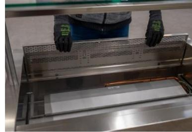
**Achtung:** Die Einhängeleisten könnten vom dem Luftleitblech fallen. Beschädigung des Verdampfers möglich!!
