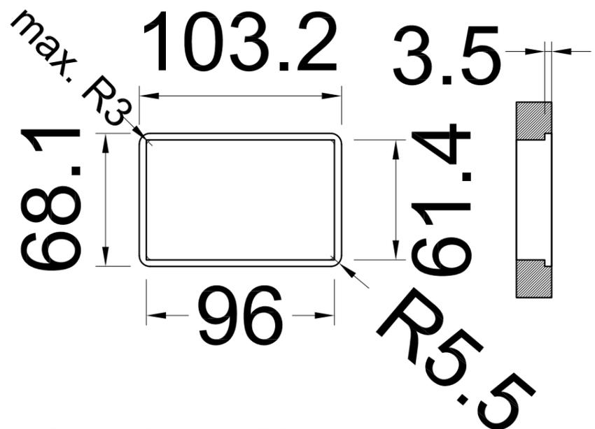
Die maximale Eckenrundung für den Ausschnitt 96x61mm darf bei Holzblenden 3mm (Fräser-Ø 6mm) nicht überschreiten!
