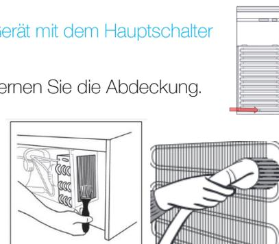
Abbildung 14: Kondensator reinigen
