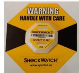
Abbildung 4: ShockWatch Indikator
