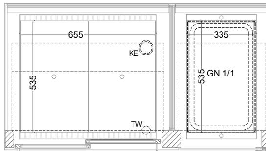
EINBAUHINWEIS: Die Wärmesteuerung muss vom Propan-Aggregat (R290) abgeschottet eingebaut werden (Ex-Schutz).
