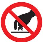
Dieses Symbol weist auf das Verbot hin, Arbeiten an spannungsführenden Anlagen durchzuführen, Anlagen ohne Genehmigung zu berühren, Schutzvorrichtungen und Schutzabdeckungen zu entfernen, bevor die Spannung abgeschaltet wurde.
